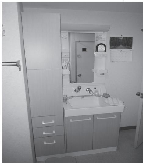
汚れが取れなくなっていた洗面化粧台を新しく取替え、お揃いの収納ボックスを設けました。日常使用する歯ブラシなどは鏡まわりに、バスタオルや洗剤などは扉の中にと、収納容量が増えてしっかり使い分けができるように！洗面台自体は壁付け水栓にしたので以前よりボウルが広くなりました。また、ボウルとカウンター、カウンターとバックガードに継ぎ目がないので、汚れが溜まらず、拭き掃除が簡単になりました。
