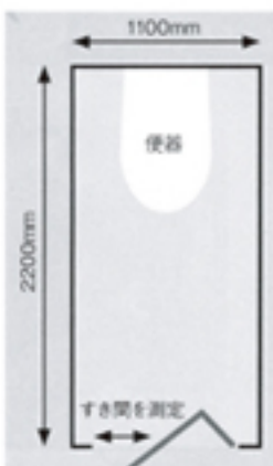
設置したタンクレス便器の先端からドアまでの距離は約1.5m。ドアはつり下げ式の折れ度を使用している。
