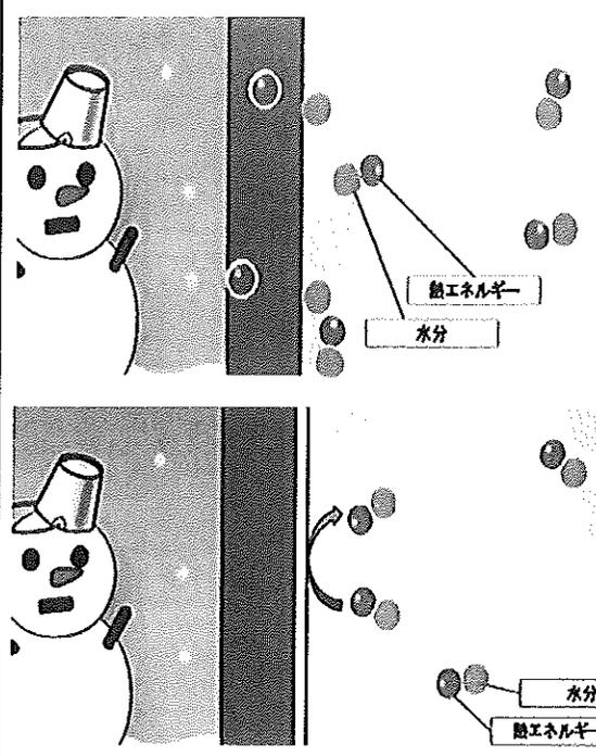
結露の原因となる空気中の水分は熱エネルギーを持ち、温度の高いところから低いところへと移動をしていきます。熱エネルギーを持った空気中の水分が壁面や天井、エアコンの吹き出し口など周辺環境より温度の低い箇所へ到達すると熱エネルギーは伝導して逃げていきますが、水分は構造体を通過できず表面に取り残されてしまいます。
