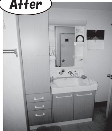
汚れが取れなくなっていた洗面化粧台を新しく取替え、さらにお揃いの収納ボックスを設けました。存在感はありますが、空間としてはスッキリまとまっています。洗面台自体は壁付け水栓で以前よりボウルが広くなりました。また、ボウルとカウンター、カウンターとバックガードに継ぎ目がないので、汚れが溜らず、拭き掃除が簡単になりました。
